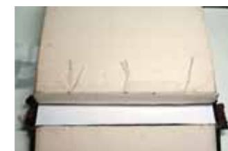
背に背紙、クータを貼り、背革に補修用革をつけ、厚紙を貼る
