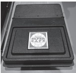
(Contact printing frame) の複製品<sup>❖6</sup>をプリントの際に使用した。そして、露光面のガラスと反ったものもあるネガ原板が密着することでネガ原板に亀裂等が生じる危険性を回避するため、ガラスを2mmのアクリル板に変更した。
